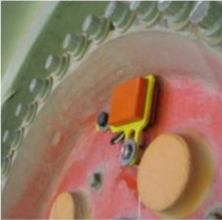
Instalado en la llanta del vehículo, este equipo permite monitorear periódicamente la temperatura del aceite de los mandos finales durante la operación del camión, permitiendo una rápida detección e intervención en caso de fallas.
