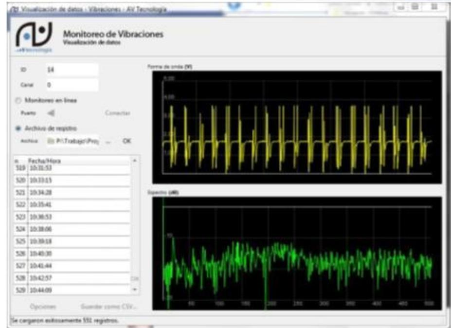
Los equipos desarrollados por AV permiten el monitoreo de vibraciones en diversas condiciones de operación y puntos de monitoreo en la pala. Los equipos tienen capacidad de medición a intervalo fijo y velocidad variable, haciéndolos útiles tanto para análisis de vibraciones en equipos rotacionales como otras aplicaciones. Los datos recopilados pueden ser analizados y exportados tanto por los equipos AV como por software desarrollado para aplicaciones específicas.
