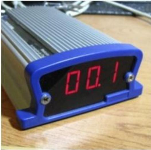
Permite medir y registrar la inclinación en 2 ejes (transversal y longitudinal) de operación de la pala con una precisión de décimas de grado. Esto permite garantizar las condiciones correctas de operación de la pala.
