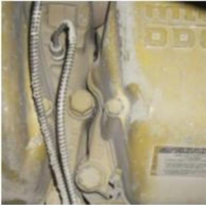
Este sistema entrega mediciones de temperatura en los escapes de cada unidad (cilindro) del motor. El equipo soporta hasta 24 sensores de temperatura independientes.
